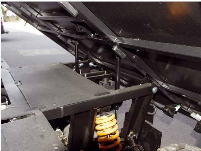
Die Pritsche wird von Hand gekippt. Zwei Gasdruckfedern unterstützen dabei und halten die Pritsche in Position
