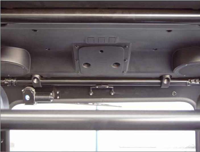
Im Dach der Kabine ist der Einbau eines Radios und zweier Lautsprecher vorbereitet
