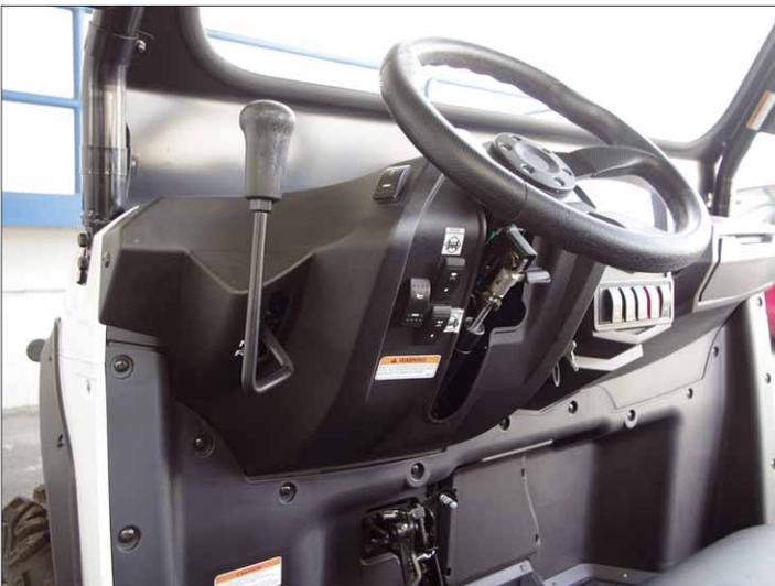
Der Wahlhebel der Automatik sitzt links, das Lenkrad lässt sich in Höhe und Neigung verstellen
