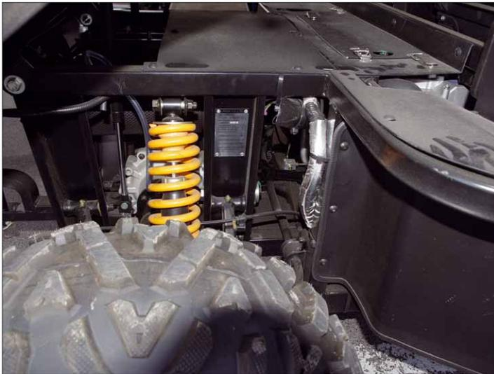
Der Motor sitzt unter der Pritsche. Standardmäßig fährt die Maschine mit angetriebener Hinterachse im 2-WD-Betrieb, der Allradantrieb kann zugeschaltet werden
