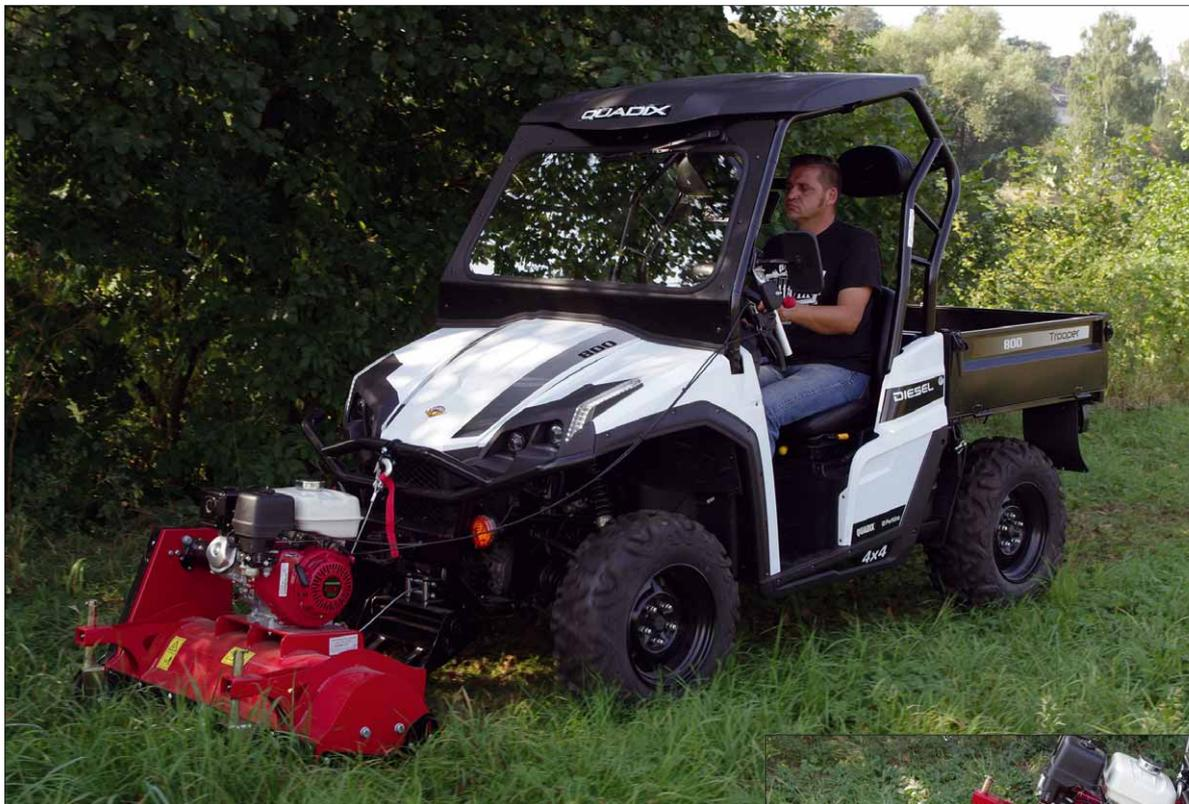
Mit Mähwerk macht der Trooper 800 eine gute Figur. Seitlich ist die Steuerung für den Mähwerk-Motor zu sehen
