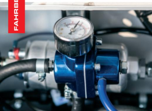
**Regelung:** Der Druckregler ist aufgrund des erhöhten Spritbedarfs und dem Einsatz einer Benzinpumpe von Bosch notwendig.
