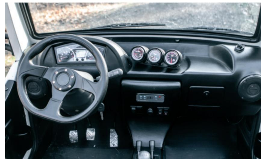
Neu: Das Lenkrad wurde bereits vor einiger Zeit durch ein abgeflachtes ersetzt. Es liegt gut in der Hand. Drei neue Instrumente informieren über die Betriebszustände des Turbos und des Motors.
