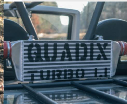
Angebracht: Der Ladeluftkühler ist wirklich riesig und liegt direkt hinter dem Fahrer und Beifahrer.
