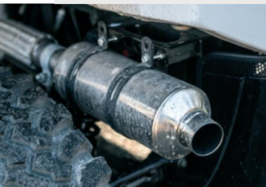
**Überarbeitet:** Das Auspuffsystem erhielt Veränderungen. So ist nur noch ein Auspuffrohr vorhanden und der Durchmesser vergrößerte sich deutlich.
