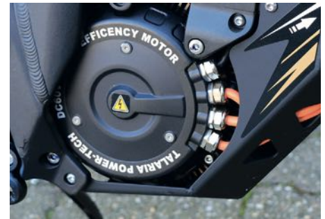
Leise: E-Motor unterhalb des Akku-Packs.
